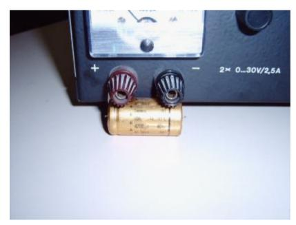
So kann der Kondensator bei Bedarf am Ausgang des Netzteiles angeschlossen werden.
