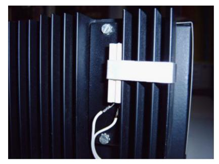
So wird der Widerstand am Kühlkörper befestigt. Der Metallbügel reicht, damit der Widerstand einen sicheren Halt hat.
