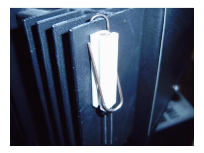
Hier wird der Widerstand einfach mit einer großen Büroklammer am Kühlkörper des Netzteiles befestigt.
