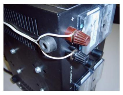
So wird der Ausgang des Netzteiles mit dem Widerstand verbunden. Die Leitungsdicke spielt keine Rolle, da hier keine größeren Ströme fließen
