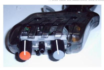
Der rote Knopf ist zum einstellen der Bremse Der graue Knopf ist zum Einstellen der Startgeschwindigkeit (Sensitivität) Der kleine Mittlere Einsteller stellt die Maximale Geschwindigkeit ein. Wurde separat in diesem Dokument beschrieben
